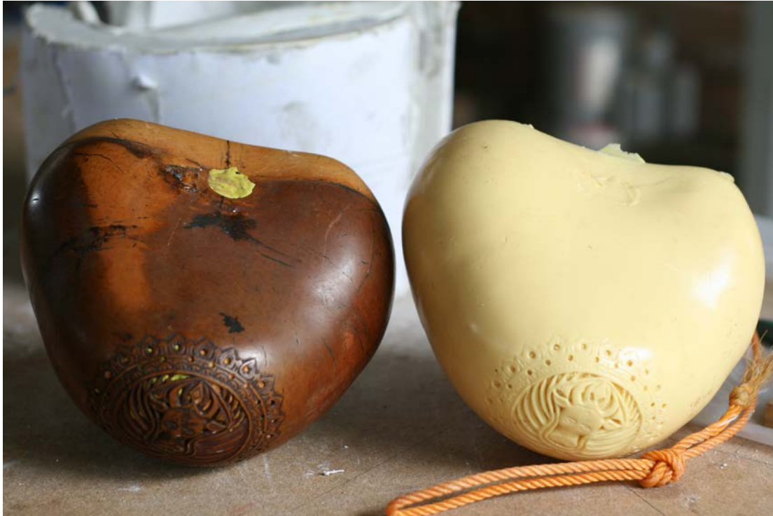
ภาพที่ 2 กะโหลกซออุ้งต้นแบบ และกะโหลกซออุ้ง “ไฟเบอร์กลาส” ที่มา : นายเมธี พันธุ์วรารทร
