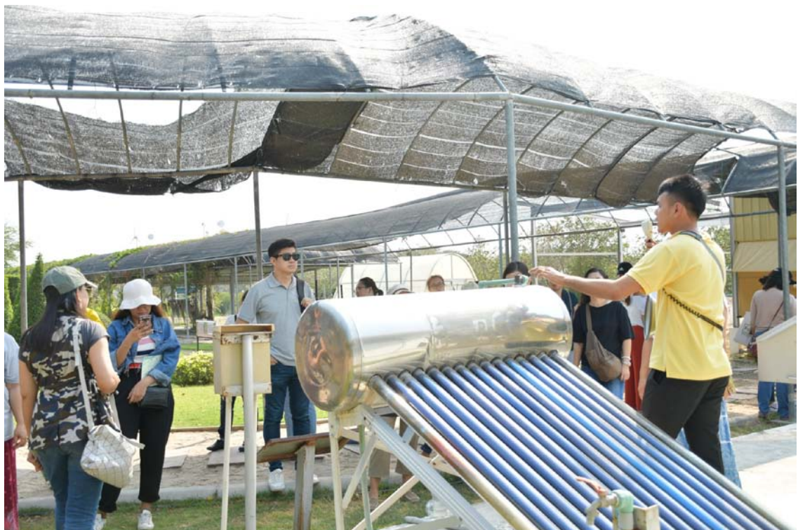
การใช้พลังงานแสงอาทิตย์ในการต้มน้ำร้อน
